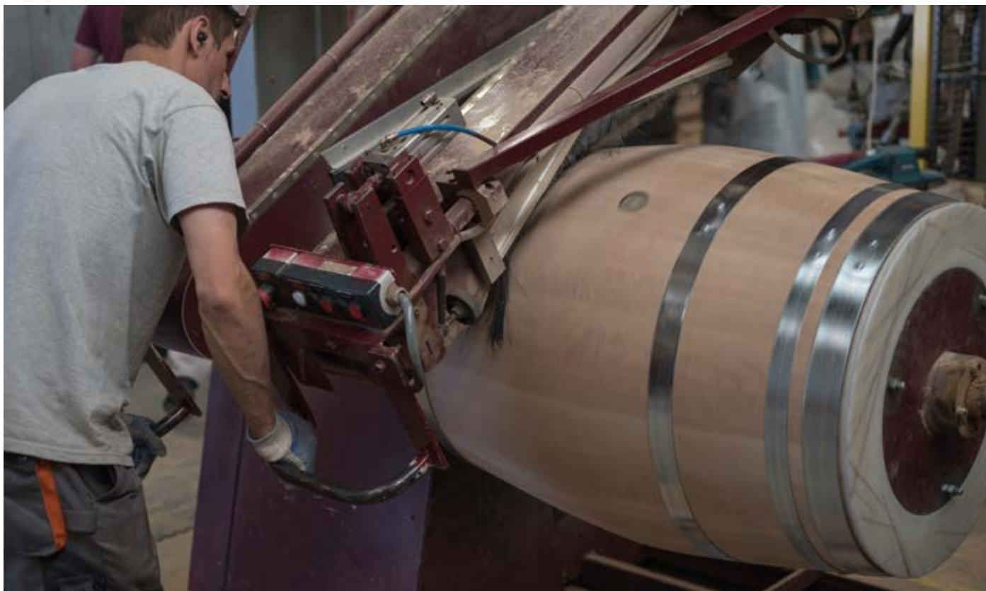
Ponçage d'un tonneau à la tonnellerie Atelier Centre France Tonnellerie. Sylvain Gaudin © CNPF.
