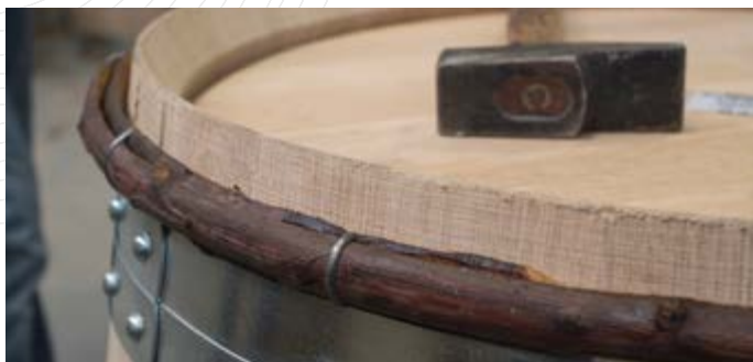
Cerclage en châtaignier d'un tonneau de chêne. Sylvain Gaudin © CNPF.
